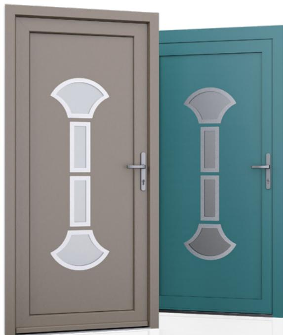
Nous proposons à nos clients des panneaux avec deux types d'âme isolante : en mousse polyuréthane et contreplaqué ou en polystyrène extrudé XPS, dont chacun peut avoir une épaisseur de 24, 36 et 48 mm. Les panneaux, en fonction des préférences du client et des exigences techniques, sont fabriqués en HPL ou en tôle d'aluminium. Les panneaux HPL sont plaxés et l'aluminium est laqué. Pour les portes en bois, nous proposons les panneaux de l'épaisseurs de 24, 36 et 46 mm.
