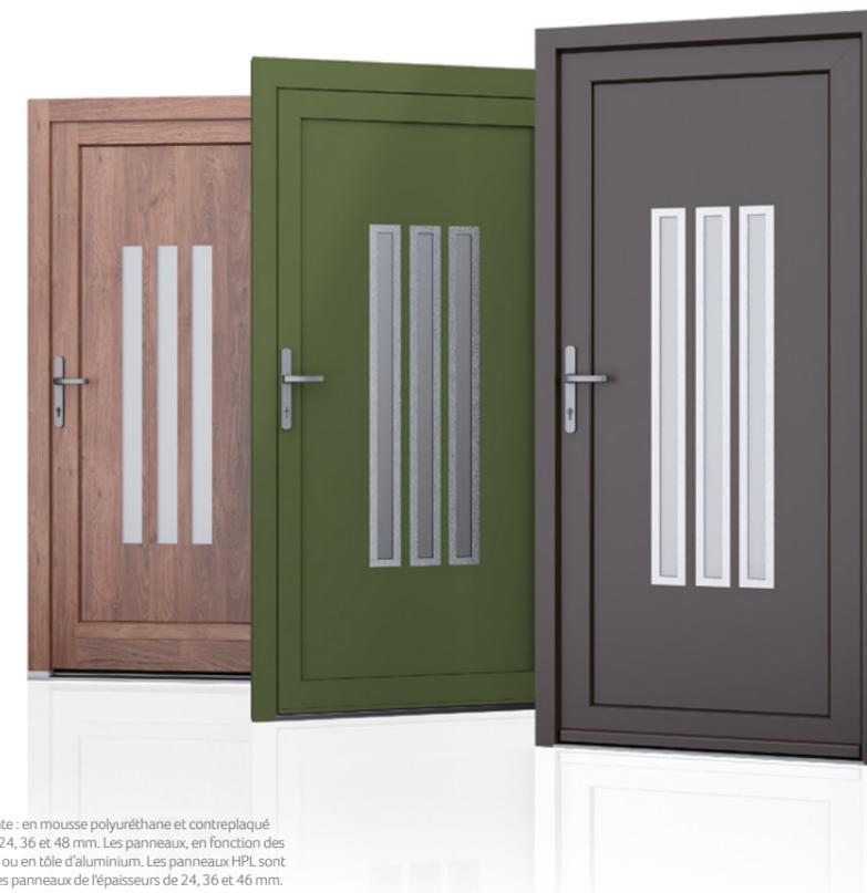
Nous proposons à nos clients des panneaux avec deux types d'âme isolante : en mousse polyuréthane et contreplaqué ou en polystyrène extrudé XPS, dont chacun peut avoir une épaisseur de 24, 36 et 48 mm. Les panneaux, en fonction des préférences du client et des exigences techniques, sont fabriqués en HPL ou en tôle d'aluminium. Les panneaux HPL sont plaxés et l'aluminium est laqué. Pour les portes en bois, nous proposons les panneaux de l'épaisseurs de 24, 36 et 46 mm.
