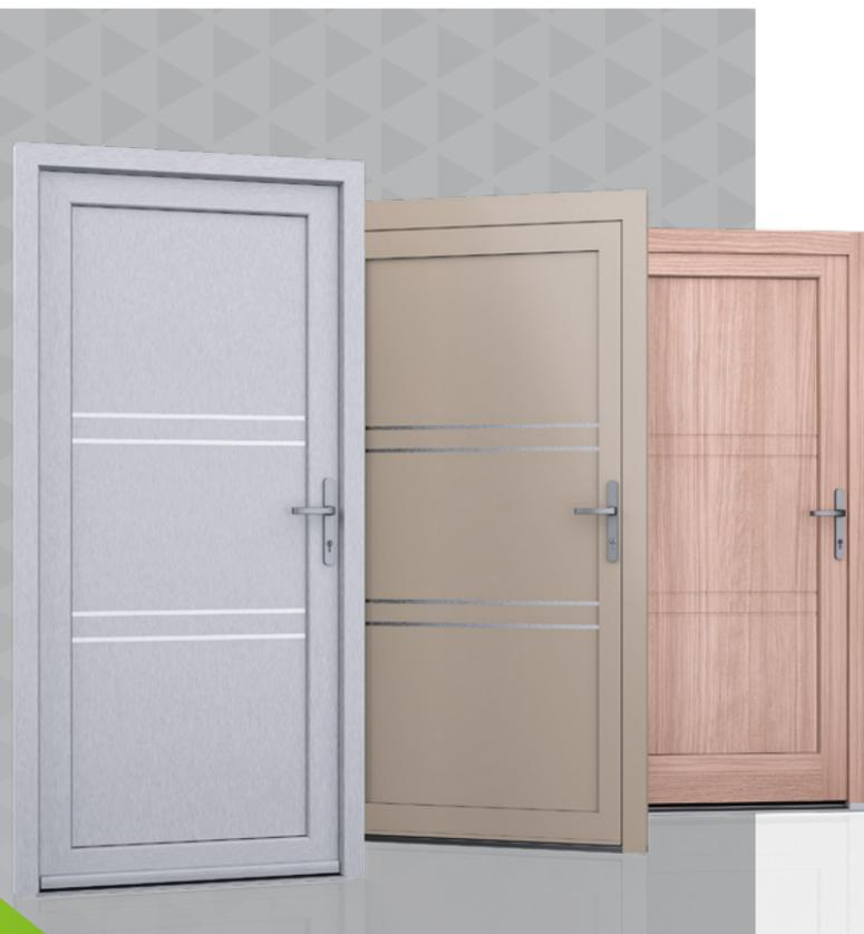
Nous proposons à nos clients des panneaux avec deux types d'âme isolante : en mousse polyuréthane et contreplaqué ou en polystyrène extrudé XPS, dont chacun peut avoir une épaisseur de 24, 36 et 48 mm. Les panneaux, en fonction des préférences du client et des exigences techniques, sont fabriqués en HPL ou en tôle d'aluminium. Les panneaux HPL sont plaxés et l'aluminium est laqué. Pour les portes en bois, nous proposons les panneaux de l'épaisseurs de 24, 36 et 46 mm.
