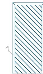
La largeur de rainure des panneaux Wood est de 4 mm.
