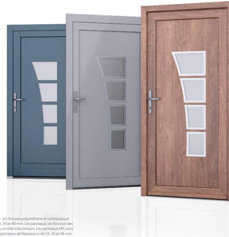
Nous proposons à nos clients des panneaux avec deux types d'âme isolante : en mousse polyuréthane et contreplaqué ou en polystyrène extrudé XPS, dont chacun peut avoir une épaisseur de 24, 36 et 48 mm. Les panneaux, en fonction des préférences du client et des exigences techniques, sont fabriqués en HPL ou en tôle d'aluminium. Les panneaux HPL sont plaqués et l'aluminium est laqué. Pour les portes en bois, nous proposons les panneaux de l'épaisseurs de 24, 36 et 46 mm.
